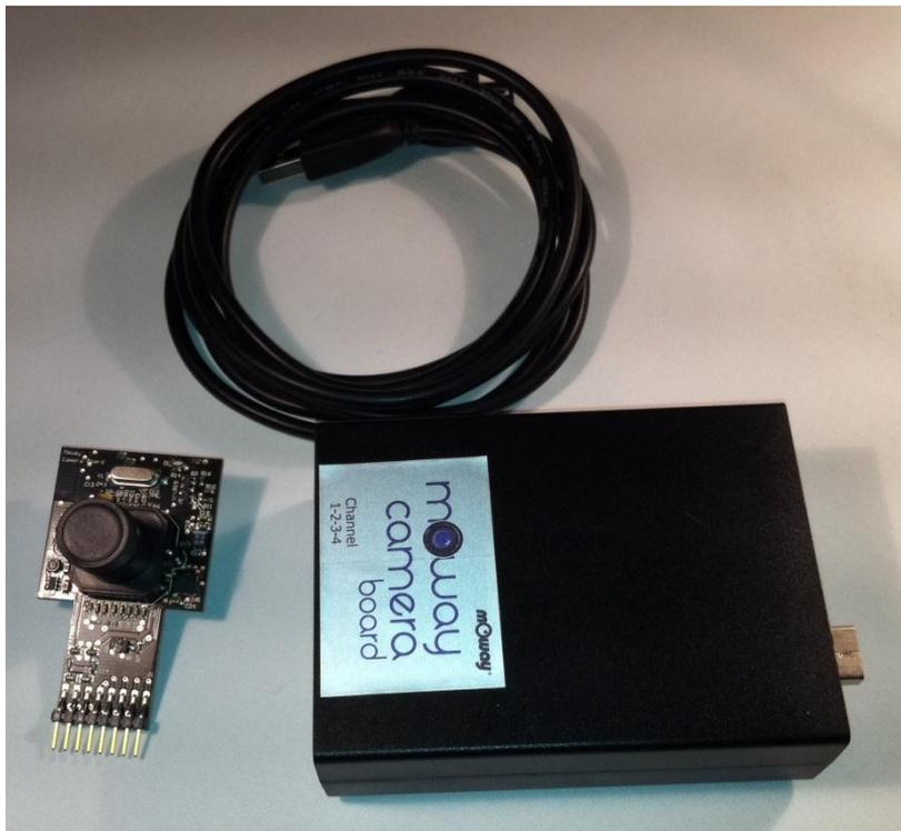
Le module caméra s'insère dans le connecteur d'extension accessible sur la partie supérieure du robot. Ce module se pilote à travers le logiciel mOwayGUI. Il incorpore en partie arrière un connecteur qui permettra de raccorder d'autres dispositifs tel que le module RF. Le boîtier de capture vidéo se raccorde à l'ordinateur via une liaison USB.
